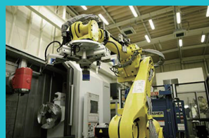
旋盤加工とマシニング加工を行う複合加工機を 組み合わせたロボット
