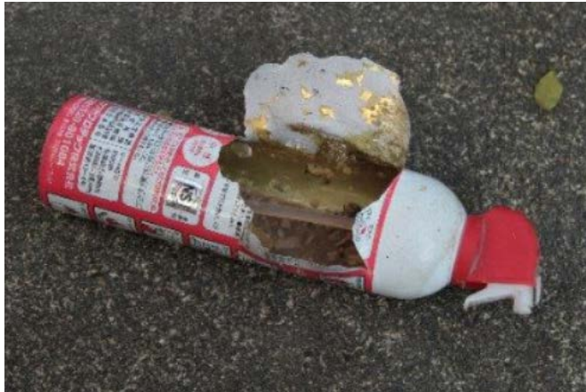
図2 内部腐食の進行により破裂した エアゾール式簡易消火具（リコール品） 5
