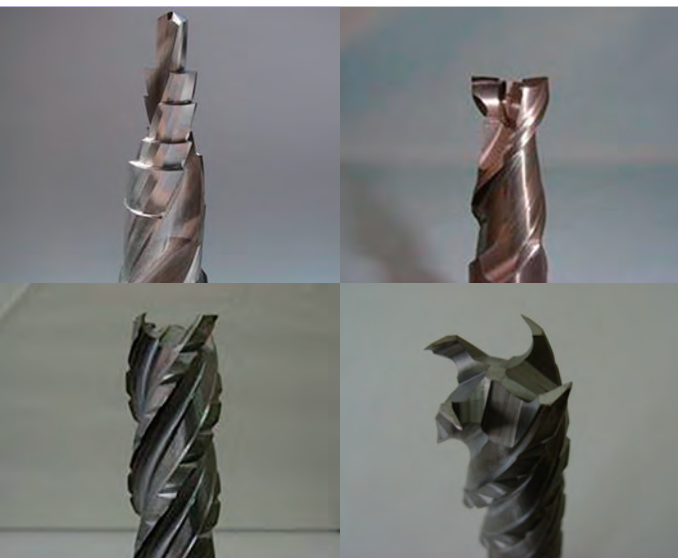
梶ヶ谷 明 (工具研磨工) 金属の切削工具(非鉄用特殊エンドミル製作)【平成25年度認定マイスター】
