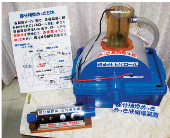
島田 昌順（電気めっき技能士） 部分補修めっき液循環装置の模型【平成27年度認定マイスター】
