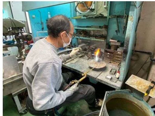
銀ロウ付け作業の様子
