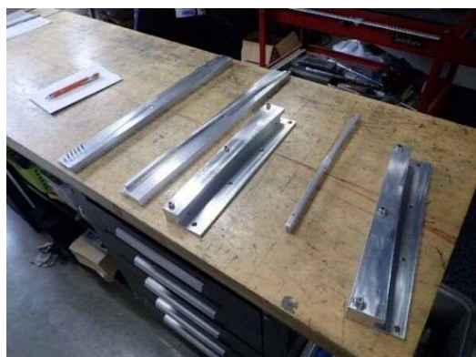
加工を補助するための治具
