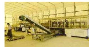
▲太陽光パネル解体装置
