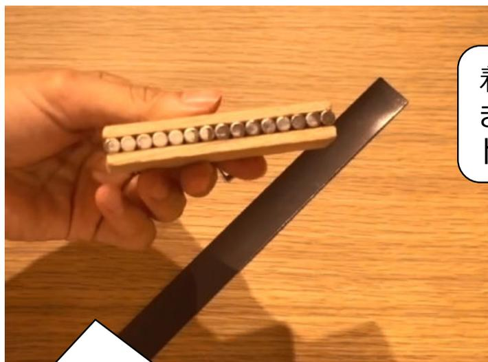
着磁器を回転式にすると、磁石の大きさが異なる着磁器を作らなくてもストライプの幅を変えることができる
