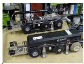
管内検査・作業ロボット
