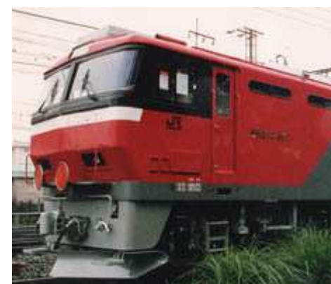
鋼板叩き出しにより電車筐体も製作
