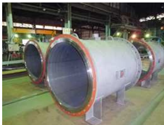
高精度の真円度が要求される、流量計 筐体の製缶も可能
