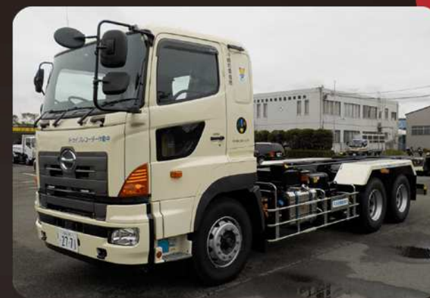
焼きゃく灰運搬車（コンテナ）
