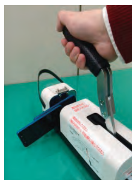
【携帯電話の穴あけ作業】
