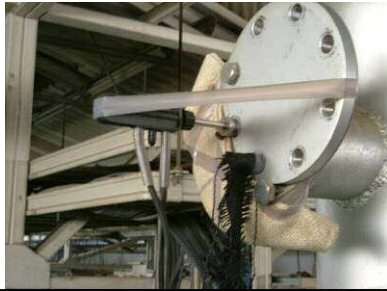
排ガス中の酸素濃度を実測
