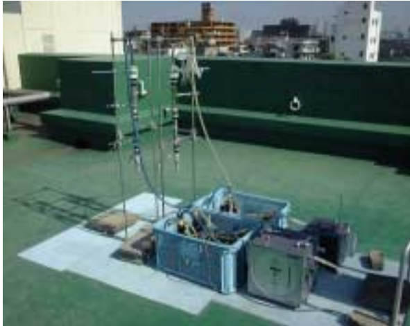
図 2 - 1 : 多重管拡散デニューダー試料採取装置
