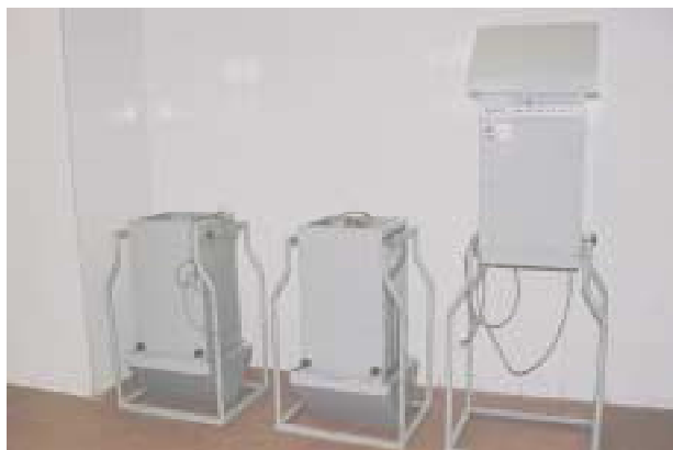
写真 3 ハイボリュームエアサンプラー（粉じん対策のためカイロセントラルセンター，地方支局に設置）
