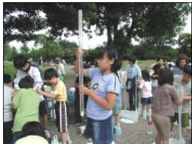
何cmかな? 手作りクリーンメジャーによる透視度測定
