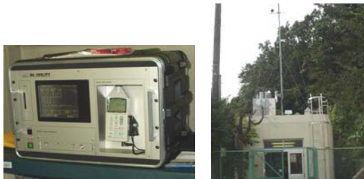
図3 航空機騒音観測装置
