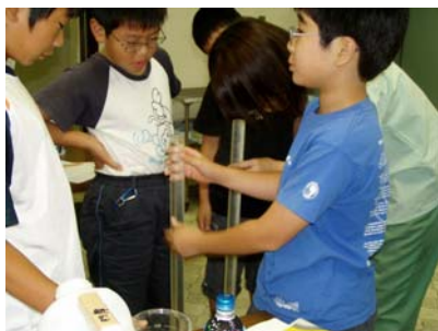
写真2 透視度を測定中
