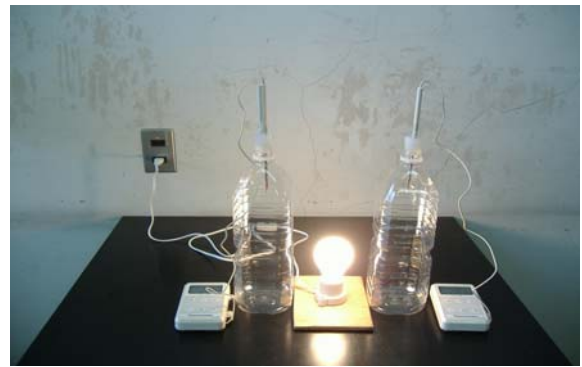
図1 ペットボトルを使用した温室効果模擬実験
