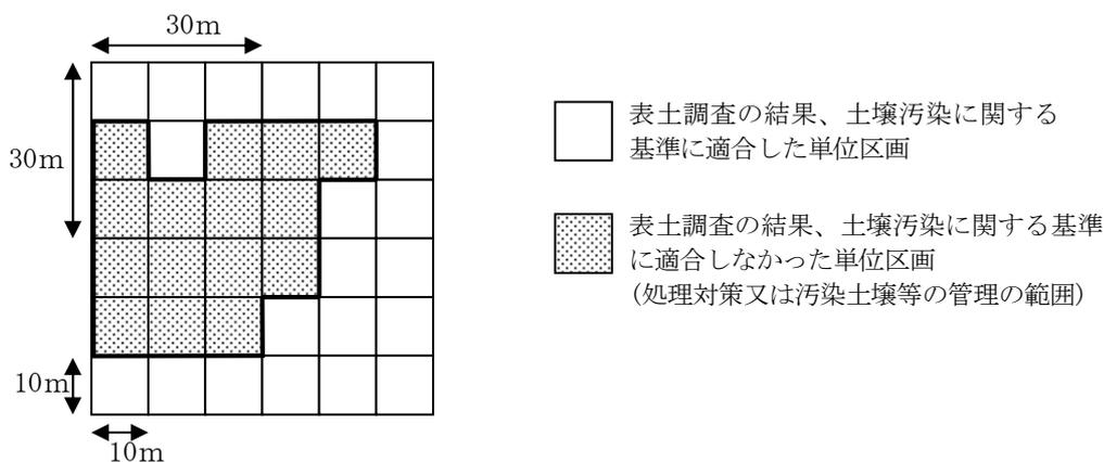
図2-1 処理対策又は汚染土壤等の管理を要する汚染土壤の対象範囲（平面範囲）の参考例
