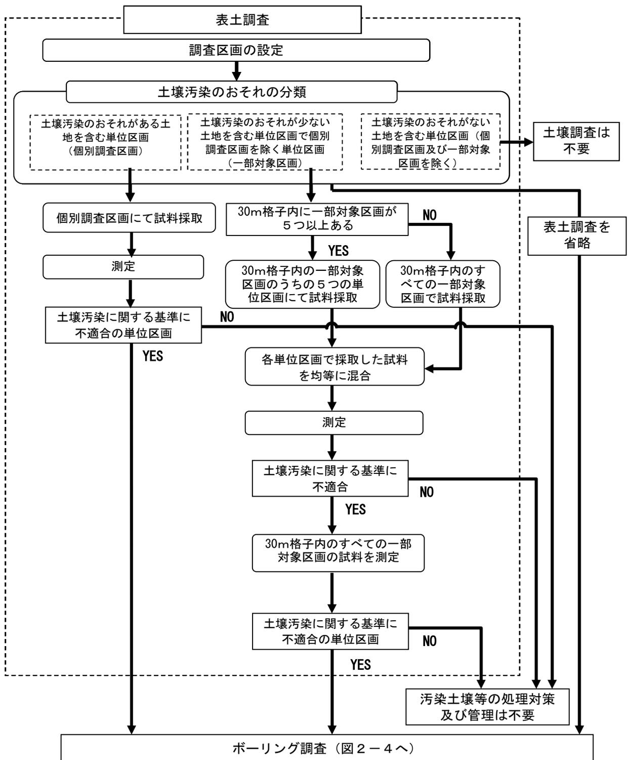
図2-1 土壤調査（詳細調査）のフロー（表土調査）
