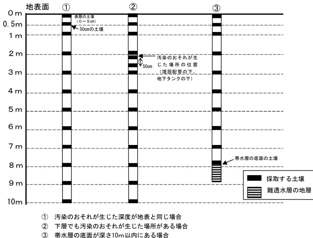
図1-7 対象地ボーリング調査における土壌試料のサンプリング深度の参考例
