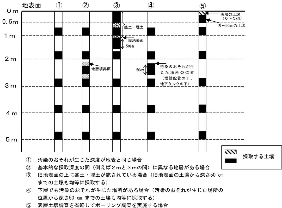
図1-6 ボーリング調査における土壌試料の採取深度の参考例
