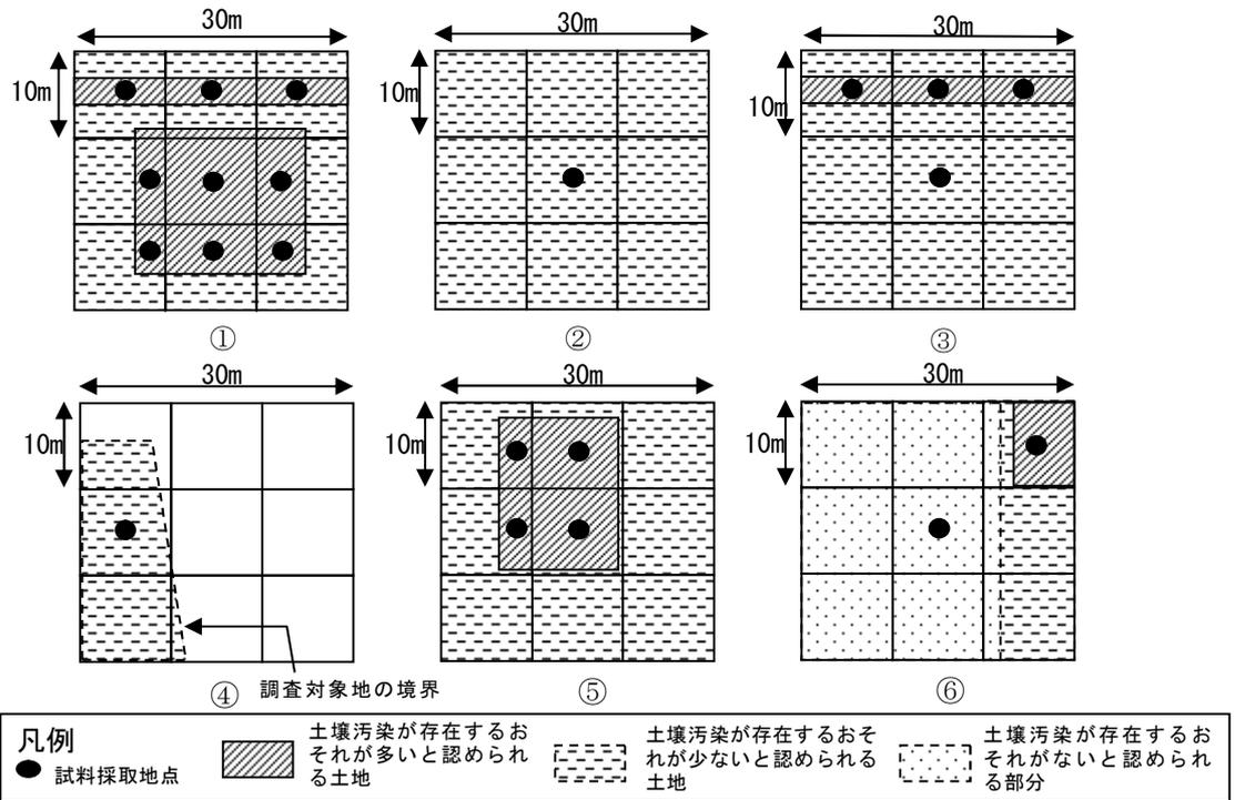
図 1 - 3 試料採取地点の配置方法の例（揮発性有機化合物）
