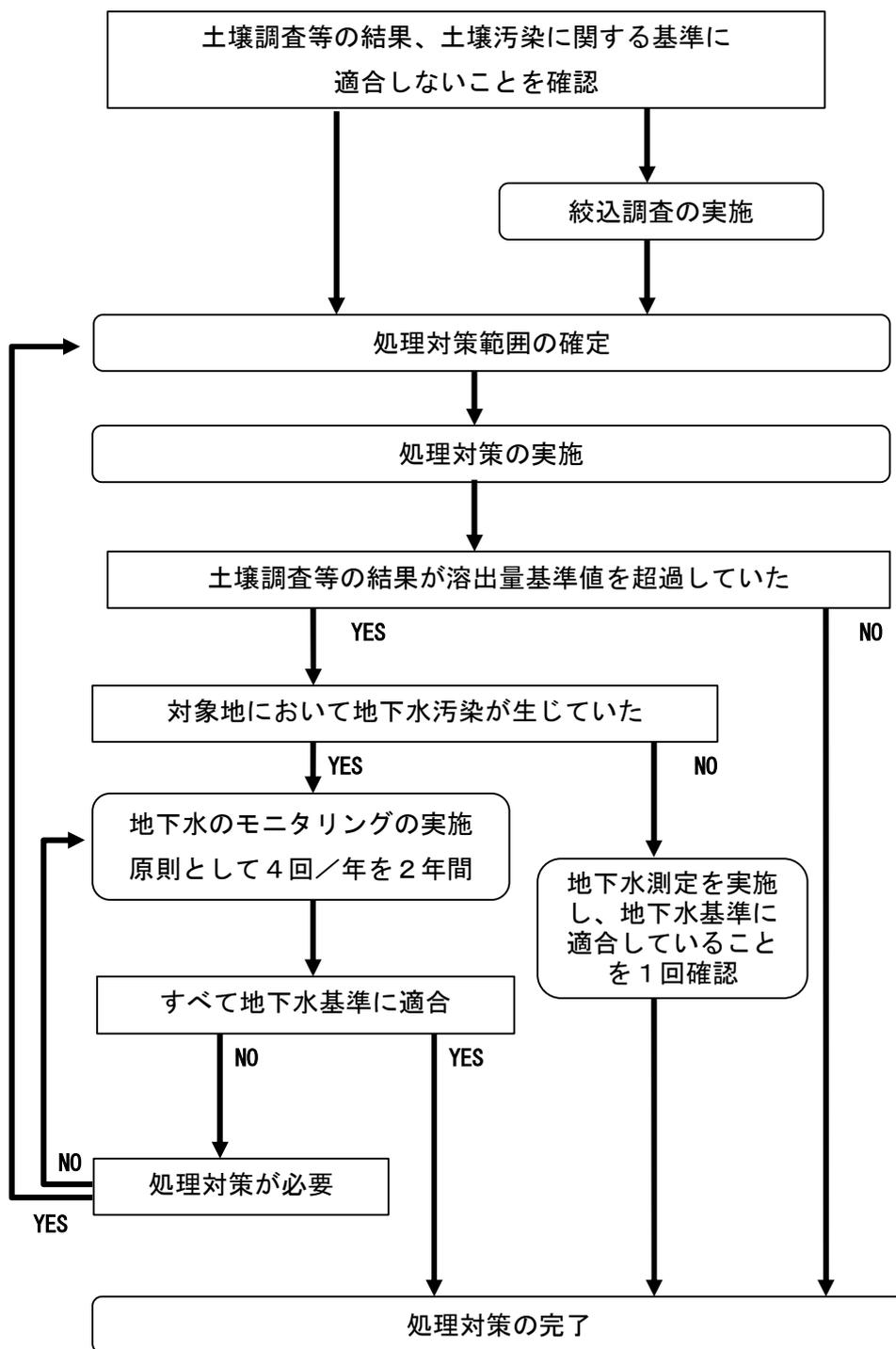
図4 汚染土壤等の処理対策のフロー
