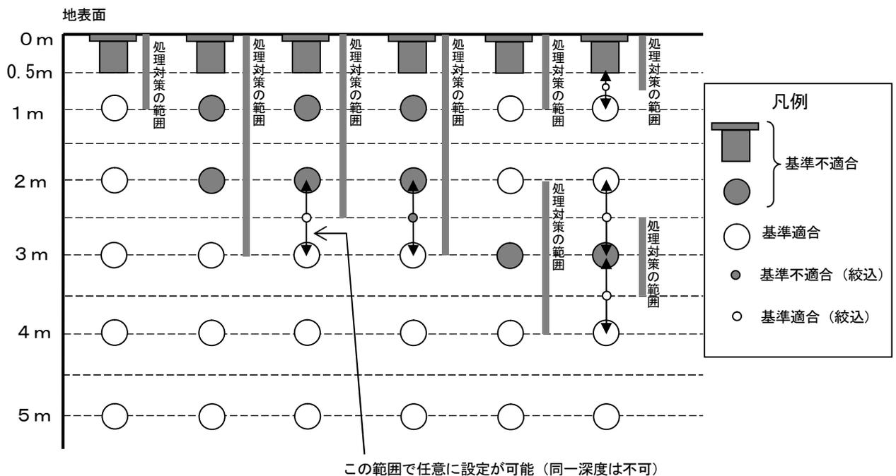
図 2-3 処理対策を要する汚染土壌の対象範囲（深度範囲）の参考例
