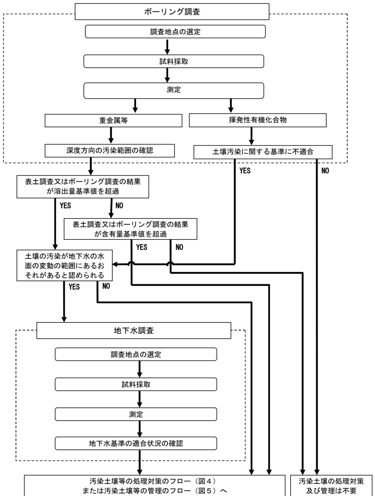
図2-4 土壤調査（詳細調査）のフロー（ボーリング調査・地下水調査）
