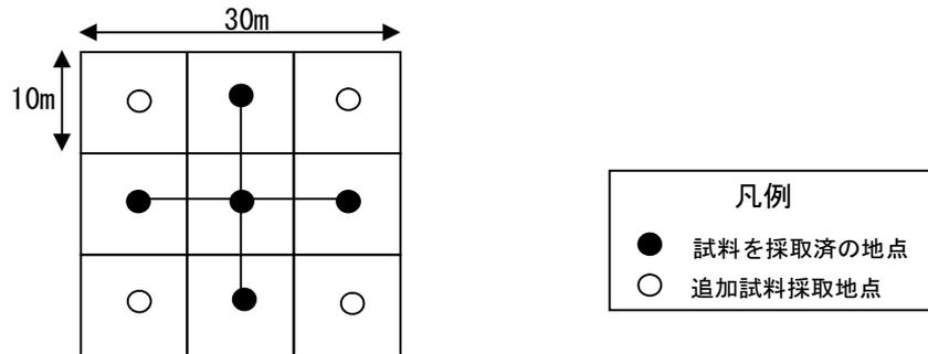
図1-2 30m格子内の一部対象区画における試料採取地点の配置方法の例
