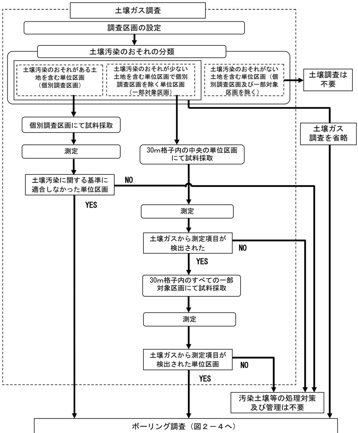
図 2 - 3 土壌調査（詳細調査）のフロー（土壌ガス調査）
