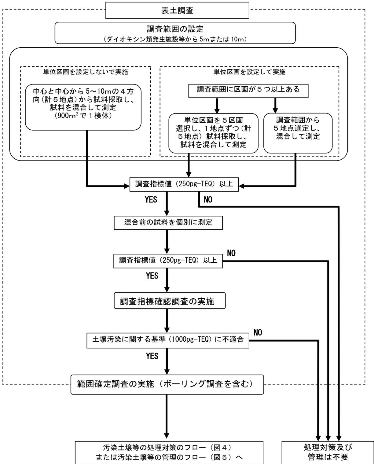
図 2-2 土壌調査（詳細調査）のフロー（表土調査・ボーリング調査）
