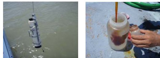
実験室に持ち帰って顕微鏡で数を数えるため、腐らないように薬品で固定している。
