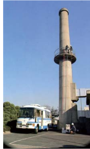
図 9 1982(昭和 57) 7 月 煙突に登り、排ガス調査を行う公害研究所の大気発生源担当のスタッフ、煙突の下のバスは、発生源測定車
