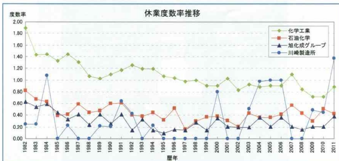
化学工業、石油化学工業、旭化成、川崎製造所（塩浜+浮島）の休業度数率* 2 推移 (休業度数率：100万延労働時間当たりの労働災害による休業者数)
