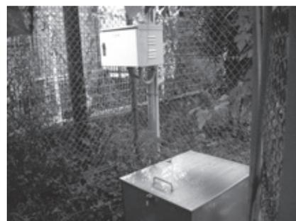
地盤沈下観測所の水位計
