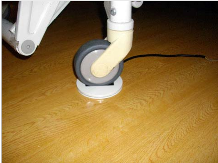
ベッド脚下に設置した起電型圧電センサー
