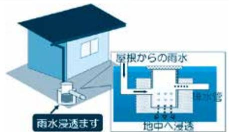
※「宅地内雨水浸透ます」とは、雨となって降り注いだ水を、「ます」の中で一時的にためて、ゆっくりと地中に浸透させる機能を持つ「ます」のことです。
