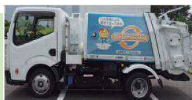
EVごみ収集車 (実施試験時使用車)
