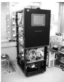
2014年度は、操作性などを改良した装置を使い3か月半にわたる長期間のフィールド実証を行い、装置の信頼性やメンテナンス方法の検証と市内のPM2.5の実態解明を行った。この共同研究により、2015年6月には富士電機としてエアロゾル分析計の製品化にもつながった。
