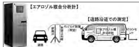
PM2.5対策には発生源の解明が重要であり、その際に必要となるのがPM2.5の粒子成分のリアルタイム測定のデータである。“エアロゾル複合分析計”はこれまで困難であった粒子成分のリアルタイム分析ができ、測定データの時間変化や気象情報等を統合して解析することで、PM2.5の実態解明のための基礎的データが得られるため、今後は将来的な排出監視に必要な技術として、PM2.5対策に関する貢献を目指していく。
