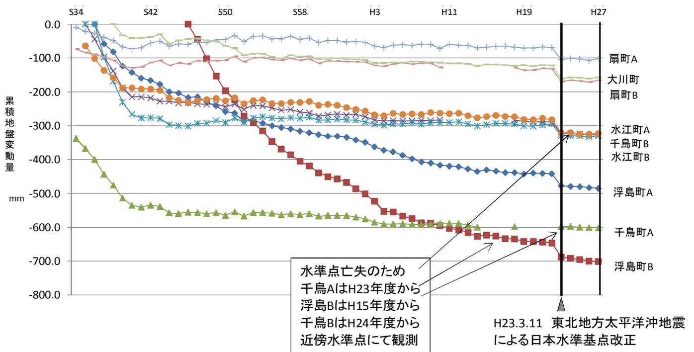
図V-9 主要水準点における累積地盤変動量の経年推移
