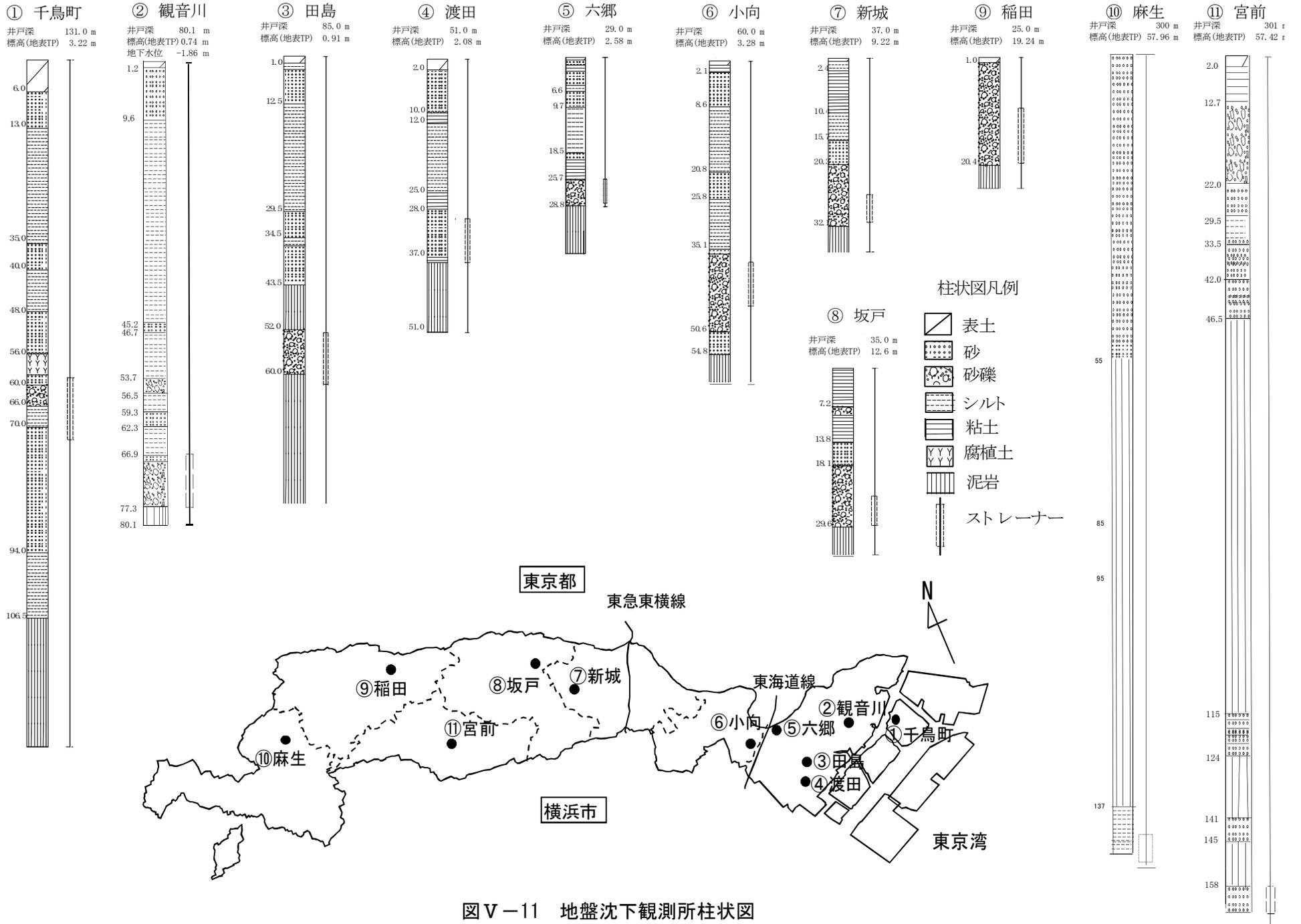
図 V-11 地盤沈下観測所柱状図
