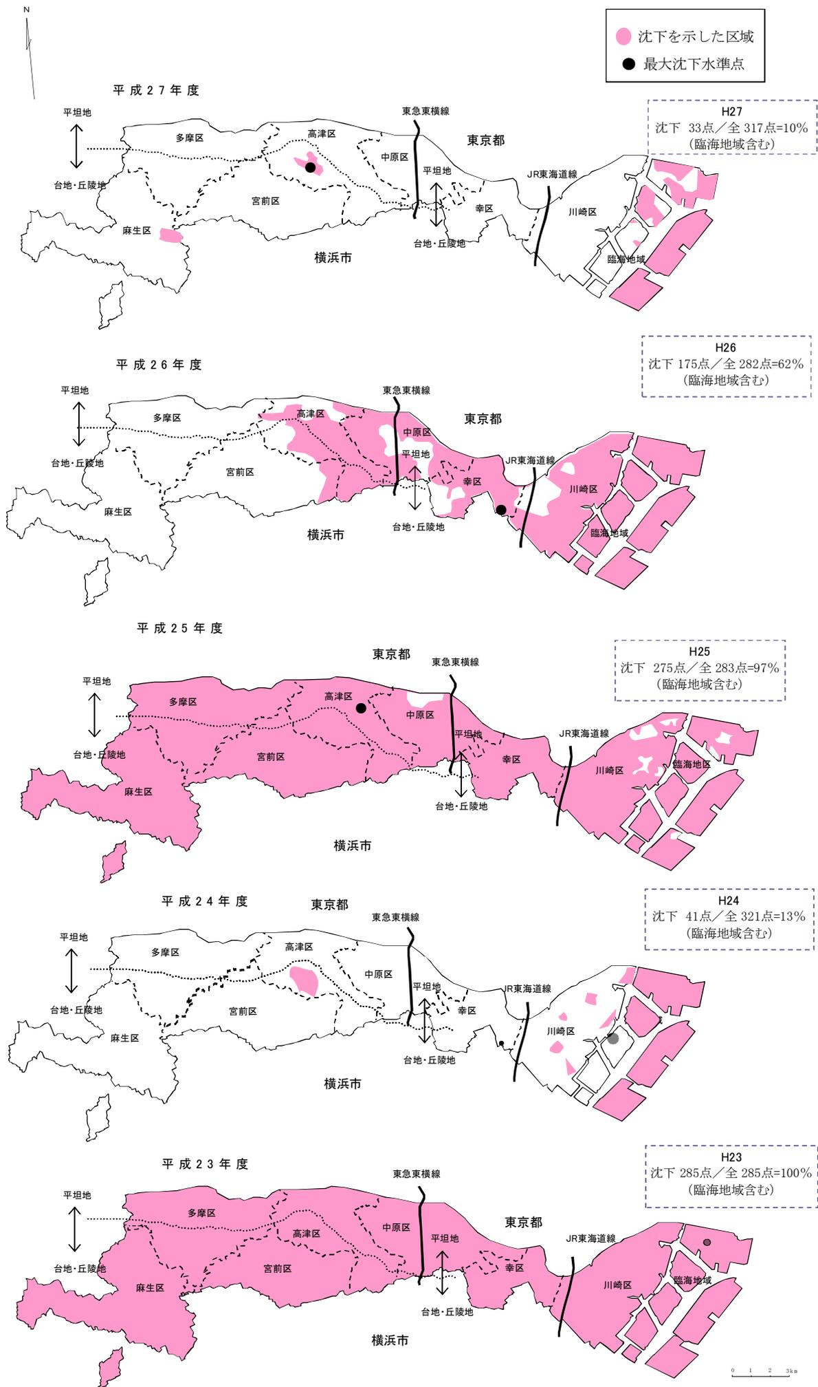
図V-5 地盤沈下区域の経年推移
