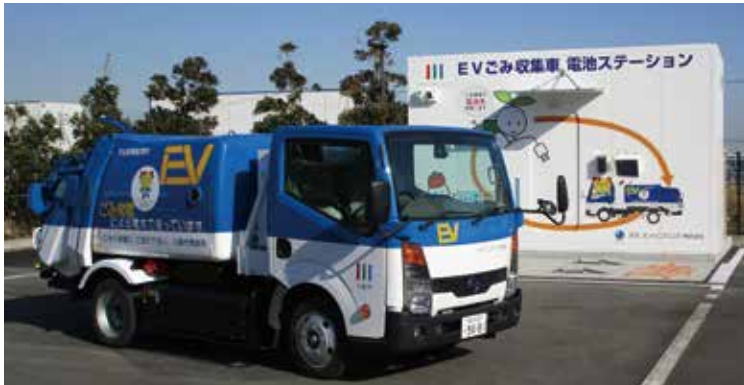
EVごみ収集車と電池ステーション
