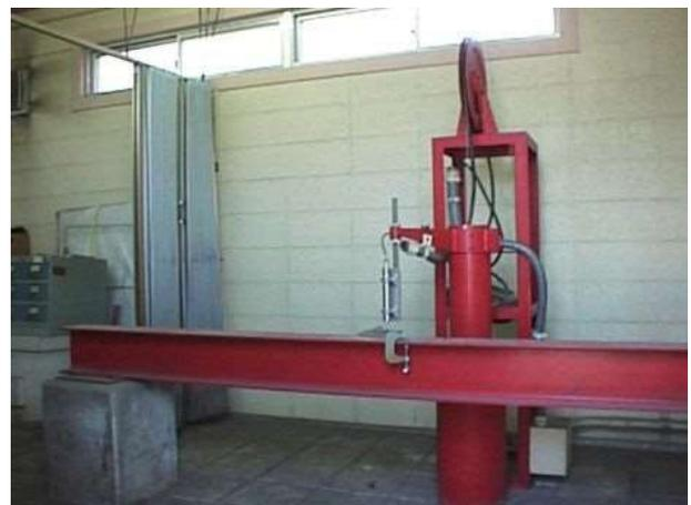
地盤沈下観測所の水位計と沈下計
