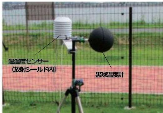
図2 温湿度センサーと黒球温度計
