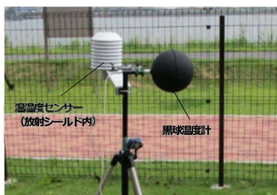
図2 温湿度センサーと黒球温度計
