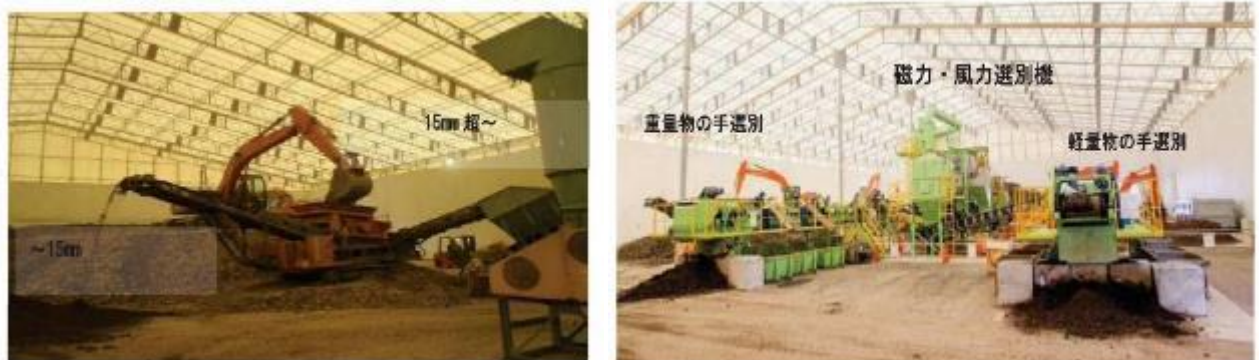
図3-11 二次仮保管場所で行う作業のイメージ (出典：平成26年8月豪雨に伴う広島市災害廃棄物処理の記録)
