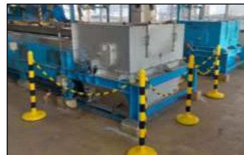
市の中間処理施設に設置した高磁力式の磁選機
