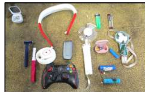
磁選機によって除去したリチウムイオン蓄電池を含む製品等
