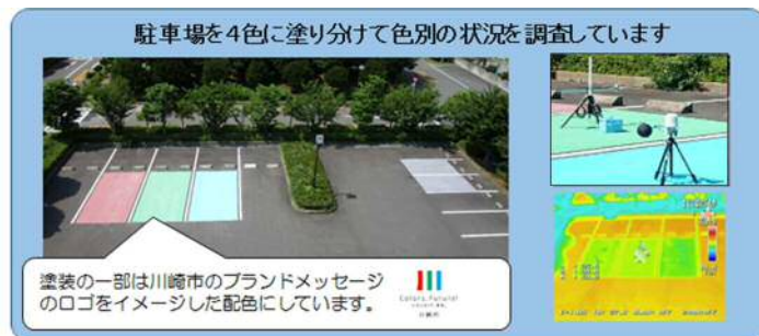
かわさきエコ暮らし未来館駐車場で遮熱塗装の検証測定機器（右上）と赤外線サーモグラフィの写真（右下）
