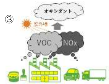
③ 光化学オキシダントの生成の仕組み
