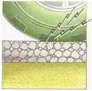
【通常舗装】 タイヤ溝と舗装面の間に挟まれた空気の逃げ道がなく、空気圧縮騒音、膨張音が発生する
