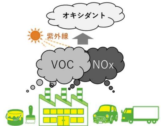
図1 光化学オキシダント発生機構
