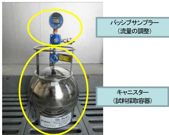
図 2 試料採取装置
