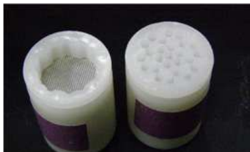
図 3 拡散型パッシブサンプラーの構造 及び拡散型（右）と改変型（左） サンプラーの写真
