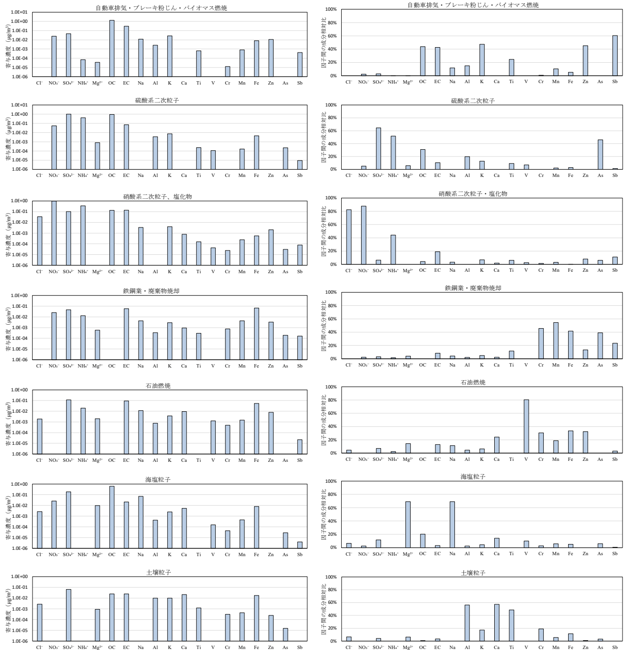
図9 発生源因子ごとの各成分の寄与濃度及び因子間の成分相対比
