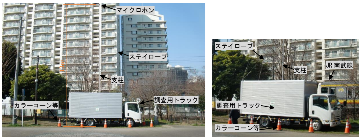
図3-8 鉛直地点の鉄道騒音調査状況（撮影日：令和4年3月10日）
