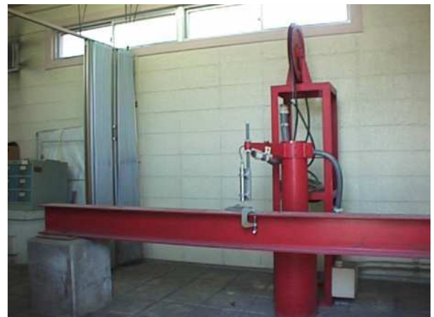
地盤沈下観測所の水位計と沈下計
