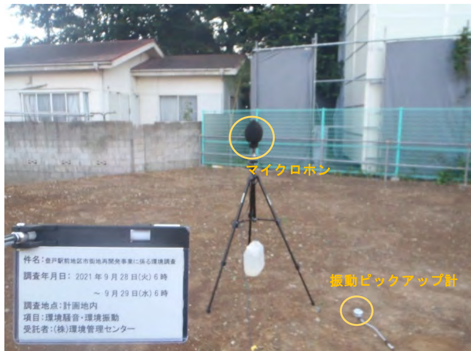
写真 4-1 環境騒音・振動現地調査状況（計画地内）
