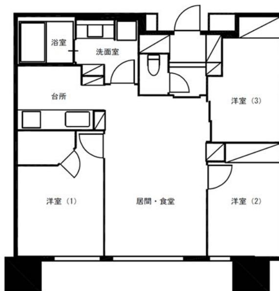
図1-11 標準住戸タイプ平面図(3LDK)(参考)
