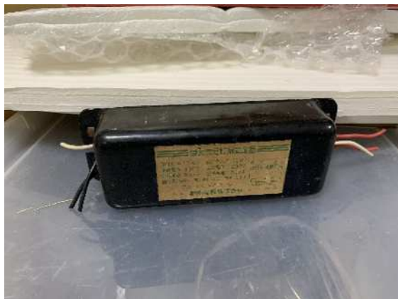
PCB廃棄物（安定器）
