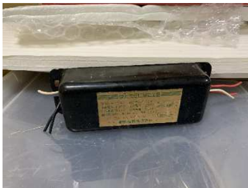
PCB廃棄物（安定器）
