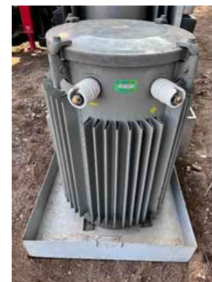
PCB廃棄物（変圧器）
